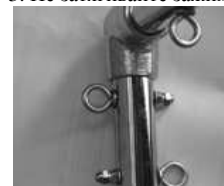
Рисунок 12 – Крепежные болты на вертикальных трубах трапедии должны быть направлены на Реформер. Горизонтальная труба устанавливается позже.
